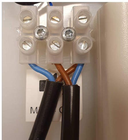
Anslutning av två, seriekopplade högtalare
